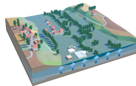
inondation de nappe
