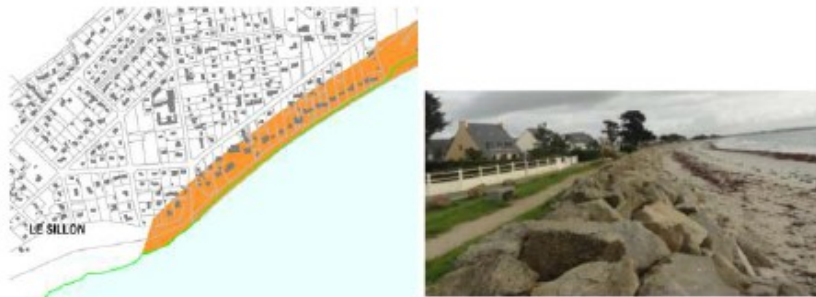
Figure 99. A gauche, aléa recul du trait de côte de référence sur le secteur du Sillon (couleur orange) et à droite, cliché de la protection en enrochements sur le secteur
