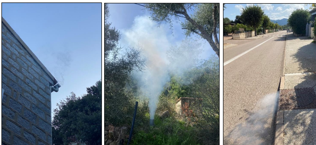
Figure 30 : Illustrations des tests à la fumée réalisées le 18 octobre 2022 sur le village de Sotta
