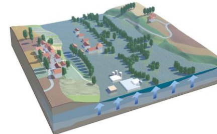
inondation de nappe
