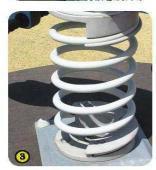
3- Le ressort est en acier 35SCD6. Sa surface est traitée après grenaillage de précontrainte puis recouverte de l'apprêt zinc et de 2 couches de poudre époxy polyester de 100 microns. La pièce de maintien (Brevet Proludic), en polyamide chargé, assure une longévité et une sécurité exceptionnelle au système.
