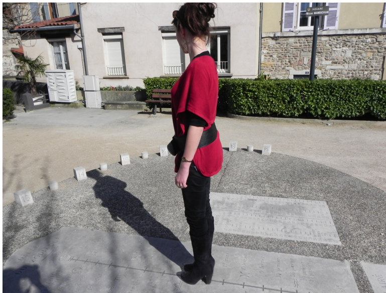
Cadran solaire analemmatique de Vienne. Une personne se positionne sur la graduation correspondant à la date du jour. Son ombre portée et prolongée jusqu'à l'ellipse donne l'heure solaire.
